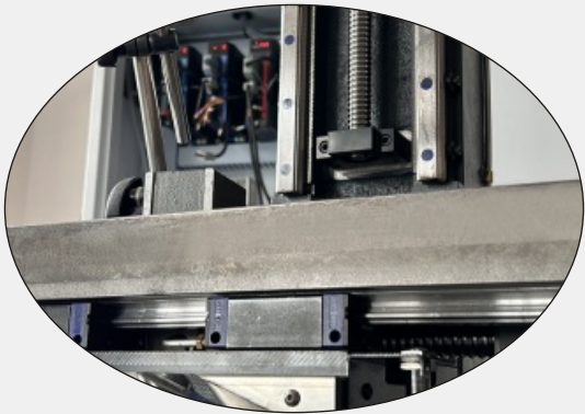
采用H级工业直线导轨、精度更高、运行速度更快
